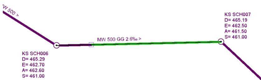
10. Fügen Sie für die eine Haltung eine neue Bezeichnung ein. Falls die Option «Höhe der Haltungspunkte interpolieren» aktiviert war, werden die Einlauf- und Auslaufhöhe am Trennpunkt interpoliert und das Gefälle neu berechnet. Falls die Option deaktiviert wurde, müssen Sie die Höhen manuell einfügen, damit das Gefälle neu berechnet wird.
